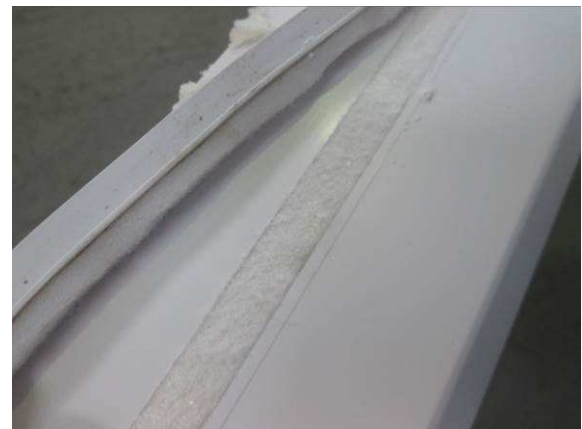
Bild 2 Materialhaftung der Anputzdichtleiste am Blendrahmen während der Demontage
