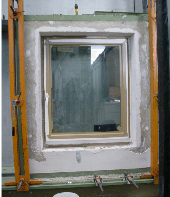
Bild 6 Probekörper auf dem Fensterprüfstand zur Prüfung der Luftdichtheit aufgebaut.
