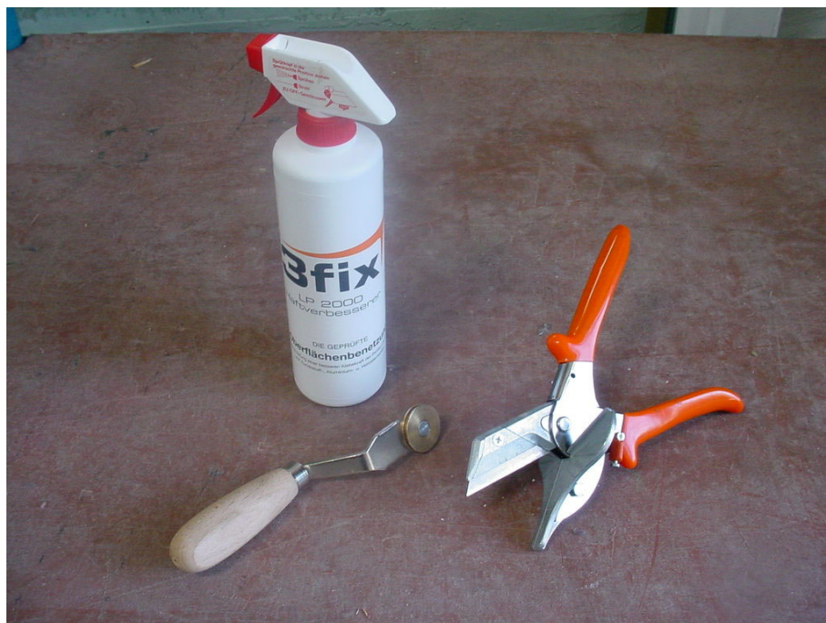
Bild 6 Hilfsmittel (3ks-Andrückrolle, 3fix-Haftverbesserer, Gehrungsschere) zur Verarbeitung des Dichtsystems
