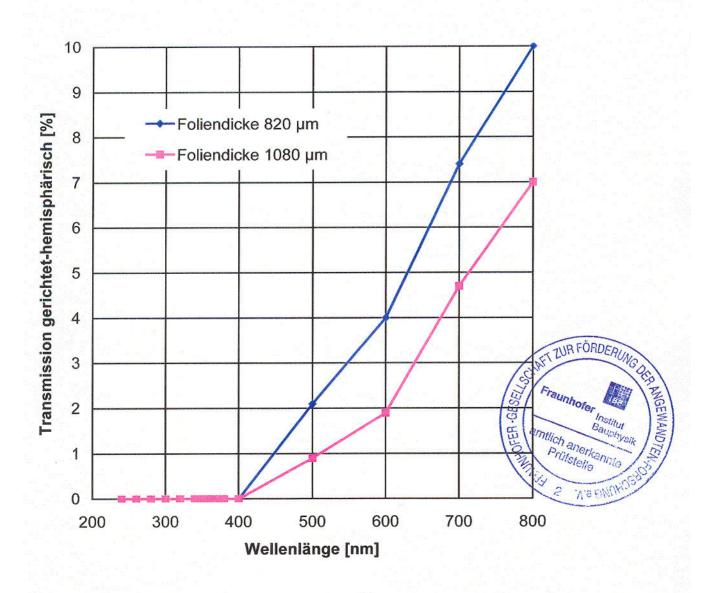
Bild 1: Transmission von Kunststoff-Folien im UV-VIS-Bereich
