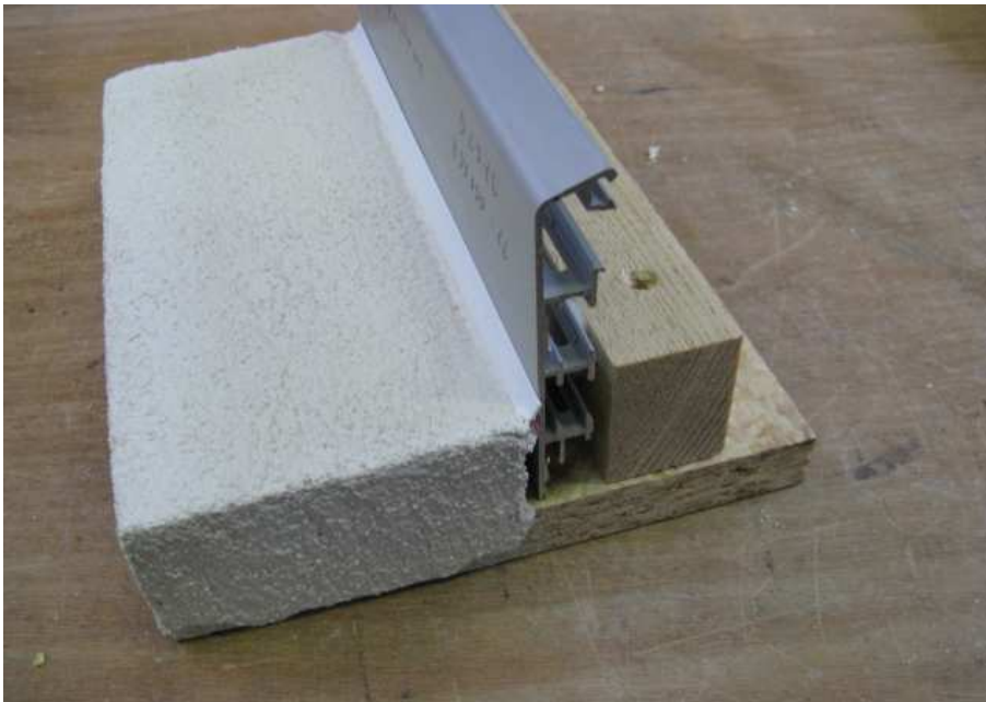
Bild 2 Probekörperaufbau für die Prüfung nach Abschnitt 4.5
