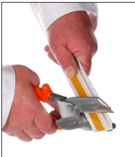
5. Zuschnitt der Profile mit T-FAL® Gehrungsschere
