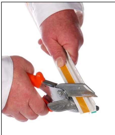
5. Zuschnitt der Profile mit T-FAL® Gehrungsschere .
