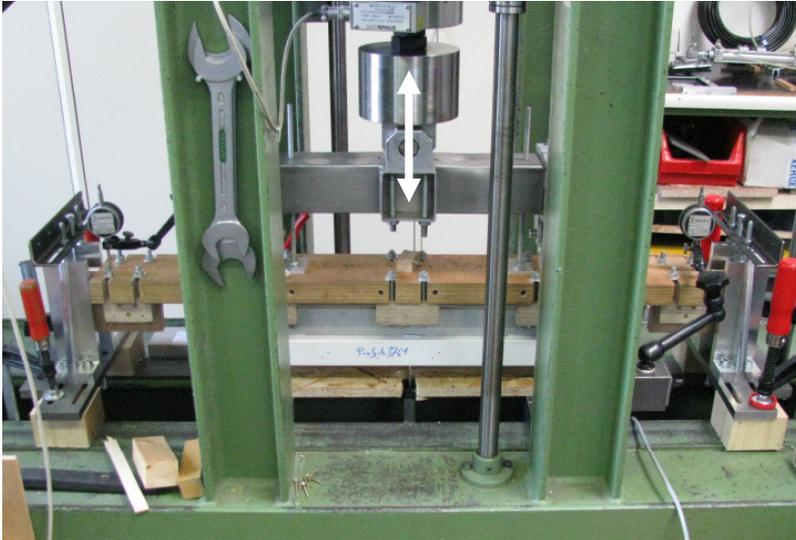
**Bild 4** Prüfaufbau wiederholte Scherung quer
