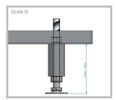
Schrauben Sie die Stellfüße M12x125 mit der Reduzierungshülse DM 30 in die vorhergesehenen Bohrungen mit der Aufschweißmutter M12. Passen Sie mittels der Stellfüße die Höhe der Edelstahlwanne an und richten Sie diese ins Wasser.
