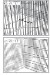
Hängen Sie nun die kurzen Abstandhalter in den Zwischenraum der entstandenen Gitterkörbe wie in der [Grafik 13/13.1] beschrieben ein. Kleiden Sie nun die senkrechten Flächen des Innenkorbes mit Folie bzw. Flies (mind. 0,2 mm) zur Trennung von Umrandung und Beetfüllung aus. Hängen Sie die langen Abstandhalter im 45° Winkel in die vier Ecken des Innenkorbes und stechen Sie dabei die Folie bzw. das Flies durch [Grafik 13.2].
