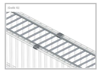
Optional: Mit einer Crimp- oder Rohrzange können Sie nun die vier Abdeckstreifen [Grafik 7] mit den C-Klammern [Grafik 8] an den inneren und äußeren Gittermatten durch einfaches klemmen befestigen.
