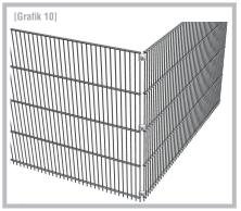
Fahren Sie nun mit dem Aufbau des Hochbeetes auf der Edelstahlwanne fort. Für den Aufbau des Innenkorbes stellen Sie zuerst die zwei 60/80 cm Gittermatten im 90°-Winkel zueinander und verbinden Sie diese handfest mit 3 Universalklemmen.
