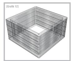
Verfahren Sie nun mit den 80/100 cm Gittermatten genauso wie bereits beschrieben und montieren Sie den Außenkorb um den bereits fertiggestellten Innenkorb.
