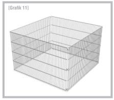
Die anderen beiden Gittermatten 60/80 cm verbinden Sie ebenso. Fügen Sie nun die beiden entstandenen 90°-Winkel zu einem Rechteck zusammen und schrauben Sie die Elemente mit weiteren drei Universalklemmen fest.
