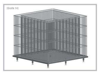
Richten Sie nun das Hochbeet im rechten Winkel aus. Anschließend werden die Universalklemmen fest verschraubt. Zur Befüllung der Hochbeetwände empfehlen wir Steinmaterial oder Glasbruch (30/60mm).
