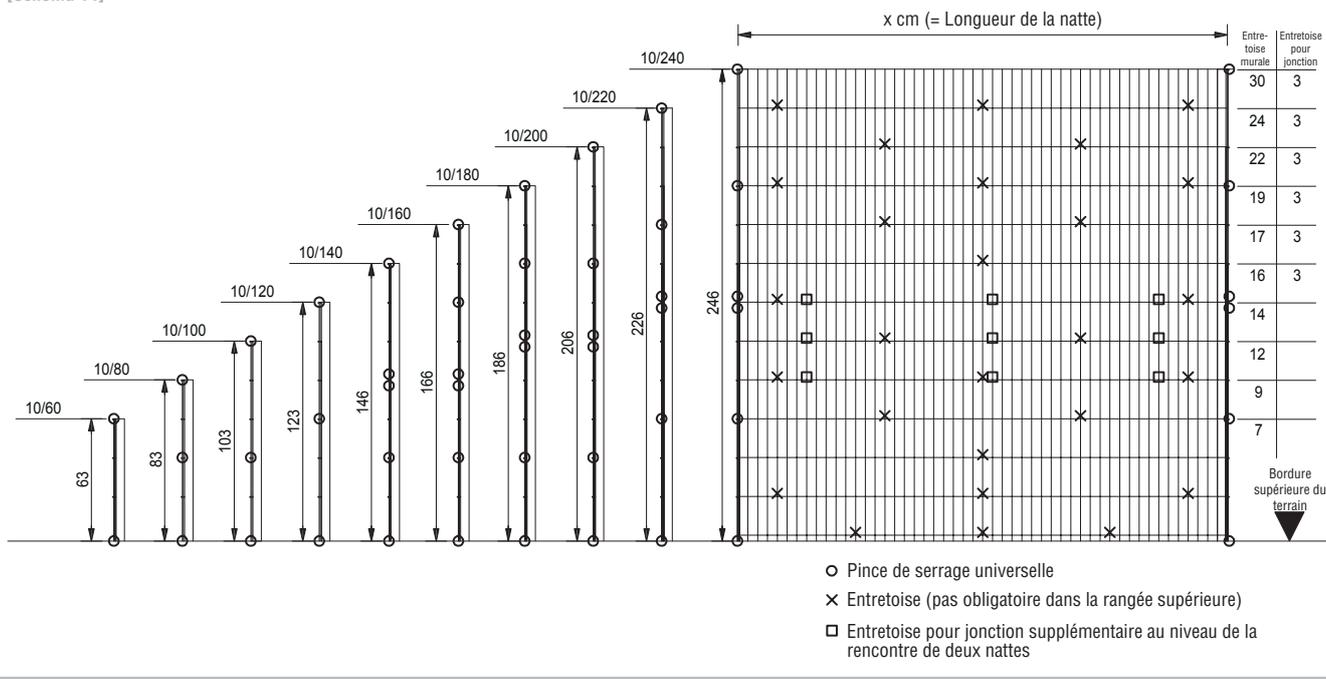
L'indication des points d'ancrage pour les entretoises constitue une recommandation et peut être étendue en option si nécessaire.
