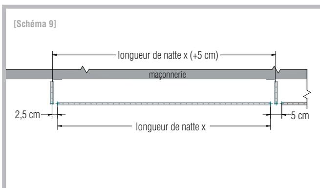
La distance X entre les rails en L est égale à la longueur des treillis souples + 5 cm (voir [schéma 14]).
