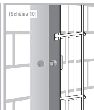
Fixer les grillages latéraux sur les rails en L à l'aide du kit de fixation [schéma 5].
