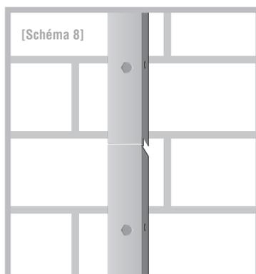
Maintenir les rails en L perpendiculairement au mur (flanc non poinçonné). Marquer l'emplacement des orifices et percer ensuite des trous pour y installer les chevilles. Fixer les rails en L en utilisant les chevilles et les vis correspondantes.
