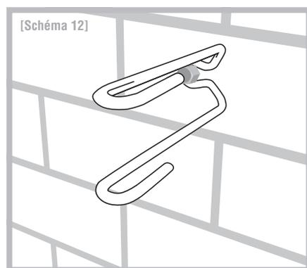
Si nécessaire, fixer toutes les entretoises pour jonction [schéma 7] au mur au niveau de la rencontre de deux grillages avec les chevilles correspondantes. A partir d'une hauteur de 140 cm, utilisation de deux grillages pour un montage et un remplissage facile. A partir d'une hauteur de 180 cm, il est également possible d'utiliser une natte de grillage.
