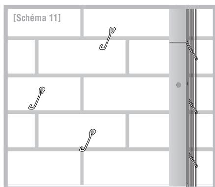
Fixer toutes les entretoises murales [schéma 6] au mur avec les chevilles correspondantes selon le [schéma 14]. Les entretoises doivent reposer sur une tringle double. Fixer brièvement les treillis souples permet de marquer sans problème les trous à percer.
