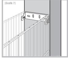
Äußersten senkrechten Stab der Gittermatten beidseitig mittels Überleger an der Außenseite des Wandanschlusses fest verschrauben. Benötigtes Werkzeug: 13 mm Steckschlüssel.
