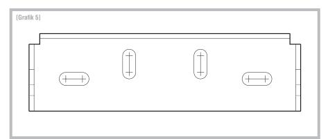
Wandanschluss einmessen und Bohrlöcher (mindestens 2 Befestigungspunkte erforderlich) am Befestigungsgrund (z.B. Mauerwerk , Beton etc.) anzeichnen. Die Anordnung (Anzahl) der Wandanschlüsse richtet sich je nach Höhe der Gittermatten nach der Anzahl der Universalklemmen [siehe Tabelle].
