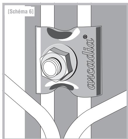
Fixez les rails en U au-dessus de chaque intersection des colonnes murales (tous les 20 cm) sur les trous carrés prévus à cet effet à l'aide d'une vis ronde plate, d'un écrou de serrage denté et d'une pince de serrage universelle.
